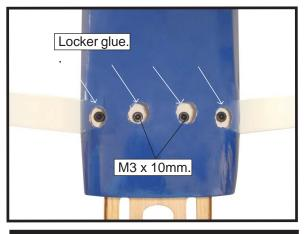
INSTALLING THE AILERON.
