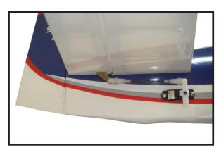
AILERON PUSHROD HORN INSTALLATION
